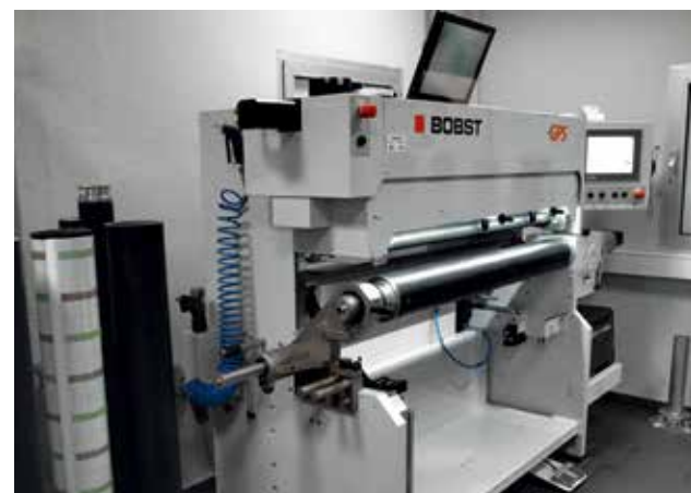
6 smartGPS montage- en topografie-inscanunit. Aftastwalsjes bevinden zich achter de sleeve. 150 flexodrukkers gebruiken al smartGPS.
