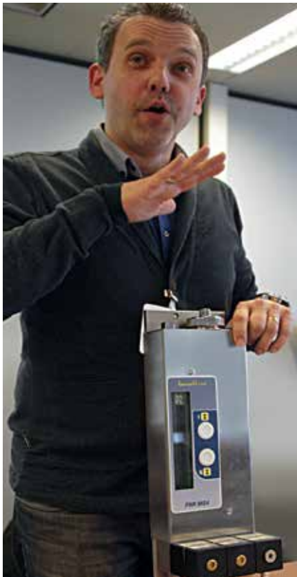
10 Fasnacht+Co's FKR MS4 viscositeitsregelaar in valkogel-uitvoering, uitgelegd door Wim Buyle.
