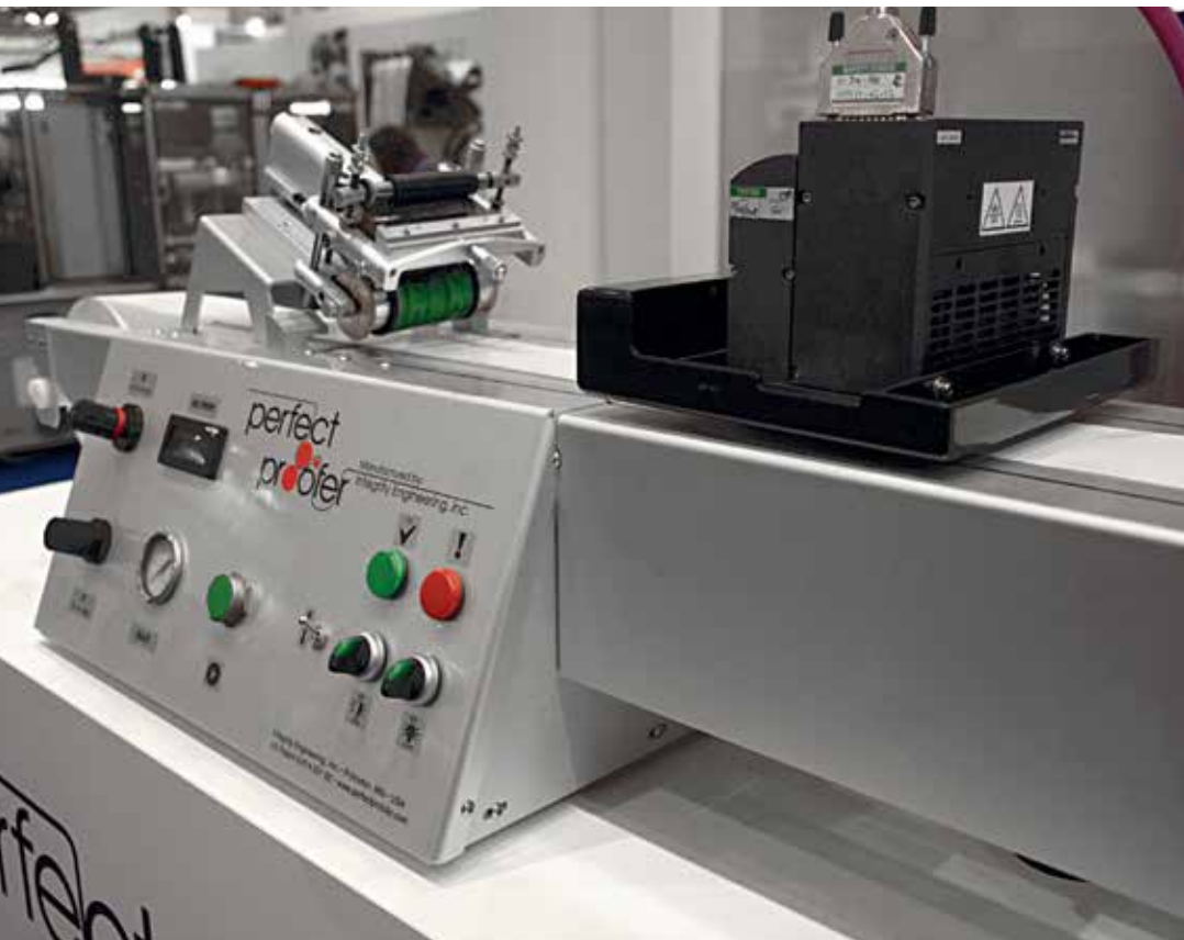
17 PerfectProofer flexodruct kleurstroken op juiste substraat.
