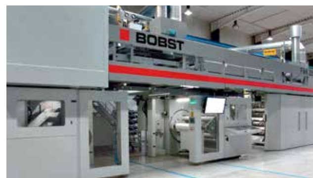
5 Nieuwe Bobst 20SIX die medio 2014 bij Flexpak arriveert. Let op de 'face-to-face' positie van af- en ontwikkelaar.
