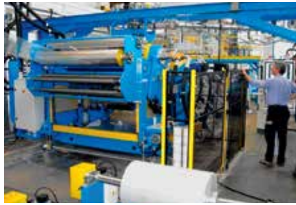
6 Bandera's kalanderunit-prototype voor PET-film.
