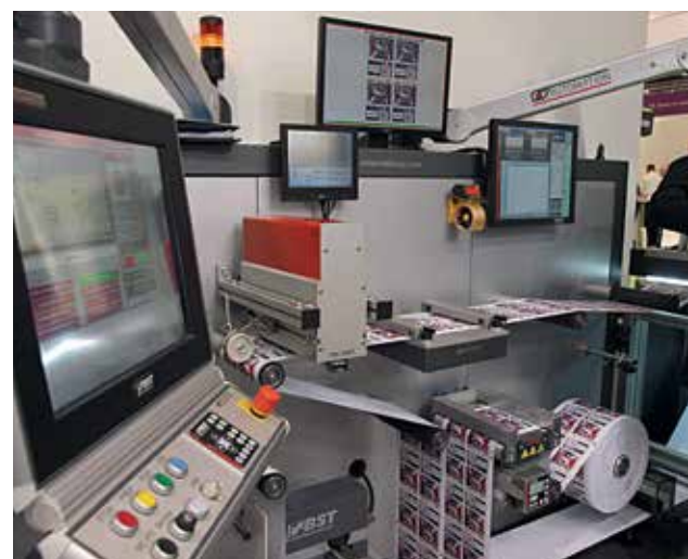
9 BST's smalbaan meet- en regelapparatuur: rode meetkop middenin = TubeScan digital strobe. Daaronder baanbesturing met een Super Handyscan. Verder: overzichtelijke bediening- en rapportageschermen.
