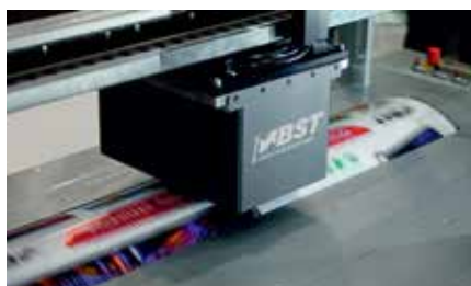
5 BST's inline-spectraalmeeetkop, onderdeel van W&H's EASY-Check C system.
