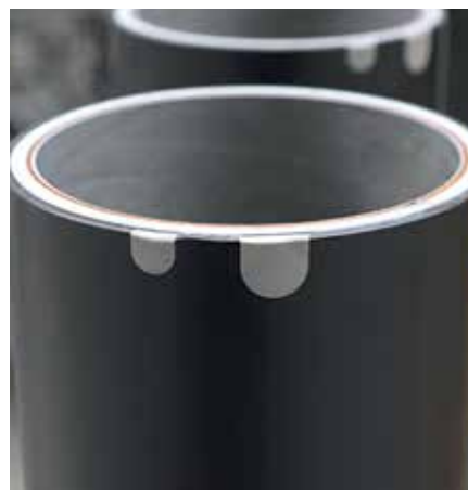
8 Twee RFID-inlays in de sleeve-mantel; voor register- en drukspanningdata.
