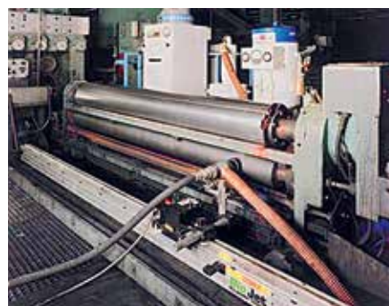
18 'BioJet' cleaning reinigt met 'bakpoeder'.
