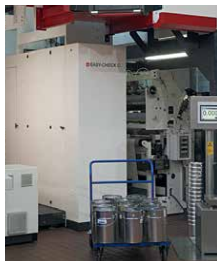
6 W&H's EASY-Check C unit met inktdoseerplaats.
