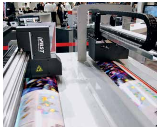
8 BST demostand met baanbreed scannende camera's. Links viewing camera Super Handyscan 400, rechts BST's inline-spectraalmeeetkop.
