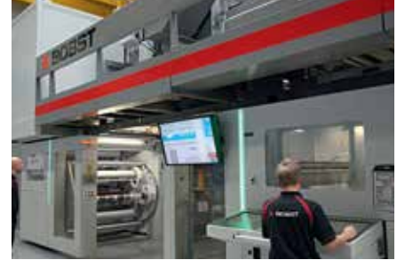
14 Bobst's 20SIX demonstreert via de groene Led-balk snel netto drukresultaat, dankzij smartGPS RFID-presetting.
